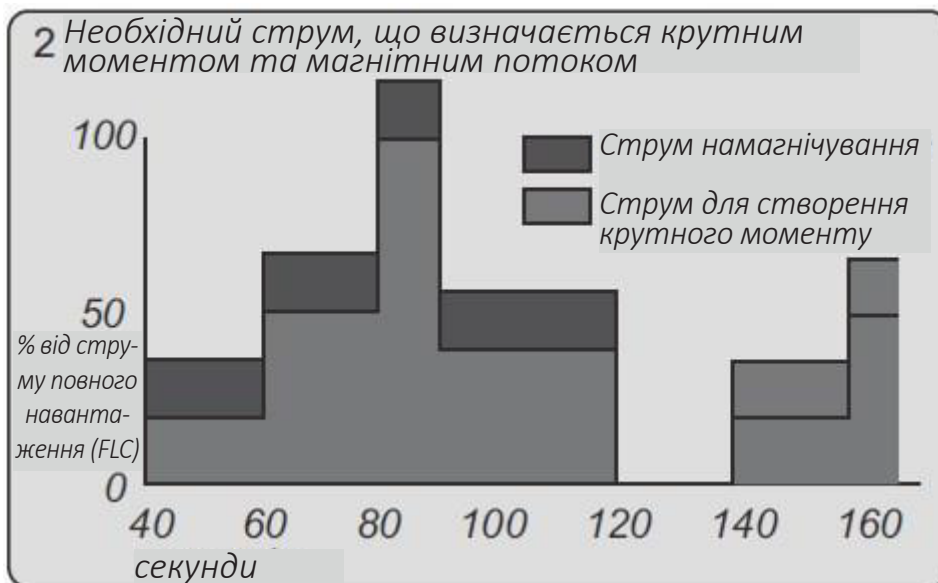
Необхідний крутний момент у перерахунку на еквівалентний струм з урахуванням додаткового струму намагнічування двигуна
